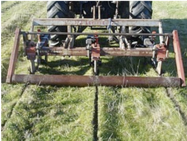
Abb. 6 Yeomans Plows, eine Art Grubber sind heute in Australien sehr verbreitet. Quelle www.yeomansplow.com.au .
